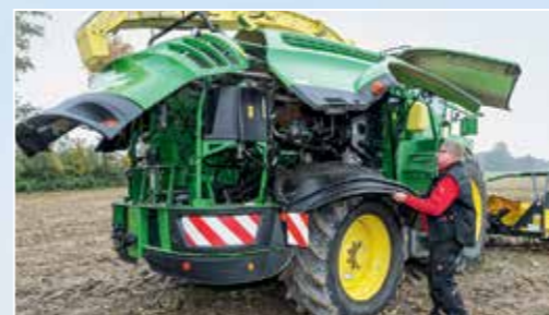
Доступ к узлам и агрегатам для проведения ТО обеспечен великолепный. Однако грязезащитные крылья без помощника устанавливать довольно хлопотно, да и допрыгнуть до открытых капотов, чтобы их снова закрыть, весьма проблематично
