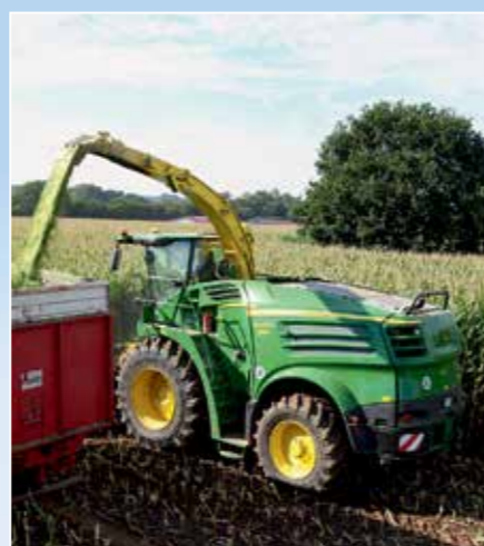
Теоретическая пропускная способность этого малыша — от 51 до 55 т сухого вещества в час — говорит сама за себя
