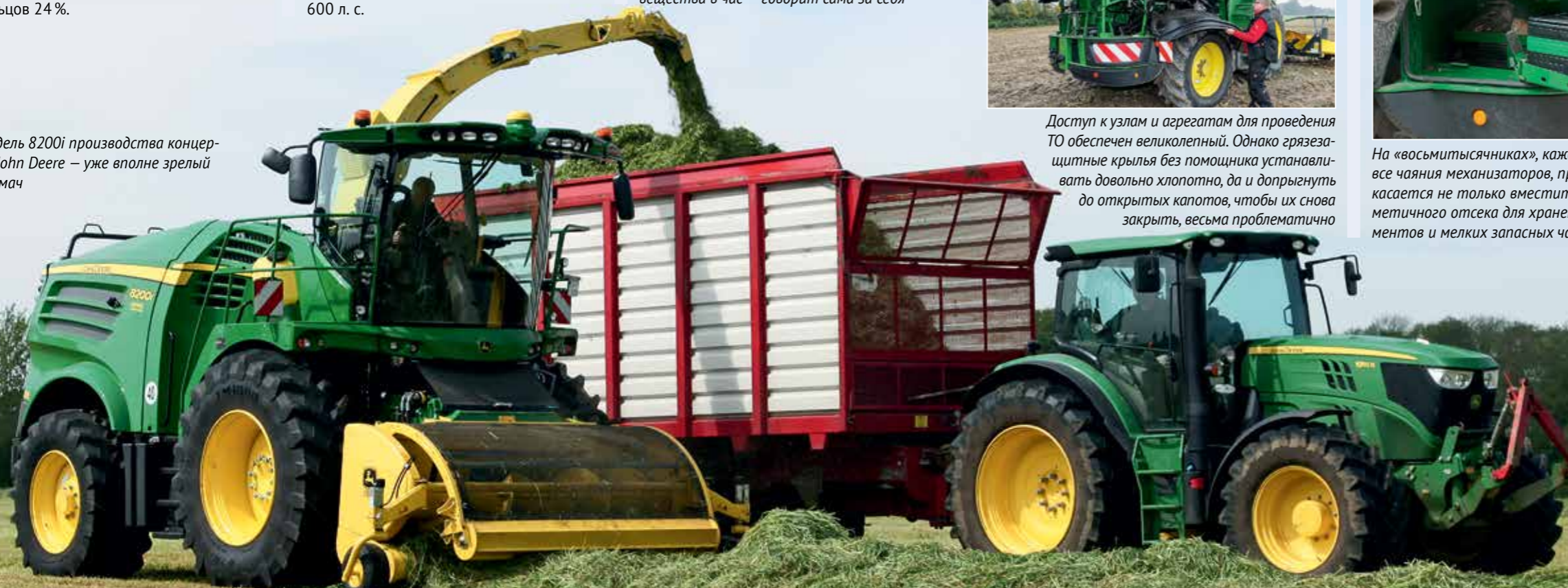
Теоретическая пропускная способность этого малыша — от 51 до 55 т сухого вещества в час — говорит сама за себя
