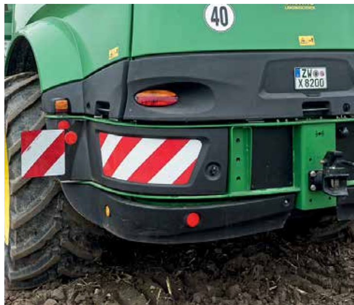
Хвостовой части недостает надежной защиты от наезда. В результате черные пластмассовые кожухи, расположенные в самом низу, особенно часто подвергаются риску поломки
