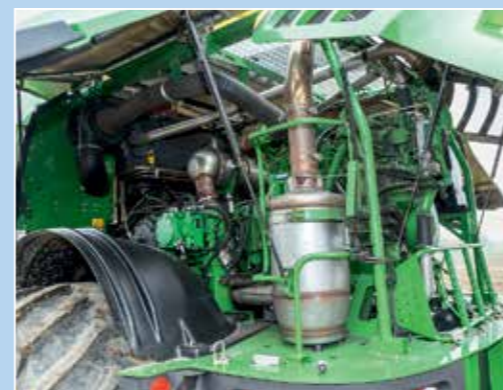
Девятилитровый двигатель с максимальной мощностью 431 л. с. в ходе полевых испытаний проявил завидную стойкость
