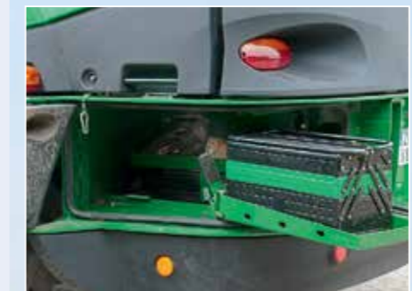
На «восьмитысячниках», кажется, учтены все чаяния механизаторов, причем это касается не только вместительного герметичного отсека для хранения инструментов и мелких запасных частей
